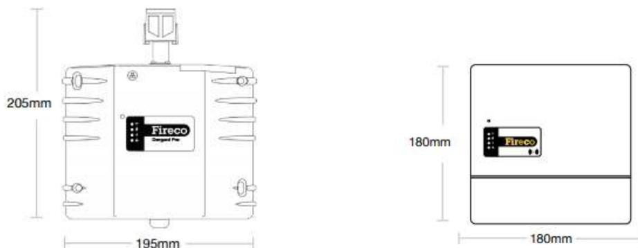
Dorgard Pro is een draadloze oplossing die u toelaat om uw branddeuren open te houden en ze automatisch te laten sluiten bij brandalarm. Optimaliseer toegangsgemak helemaal in overeenstemming met de regelgeving, veilig en legaal. Het systeem werkt radio gestuurd als akoestisch.
